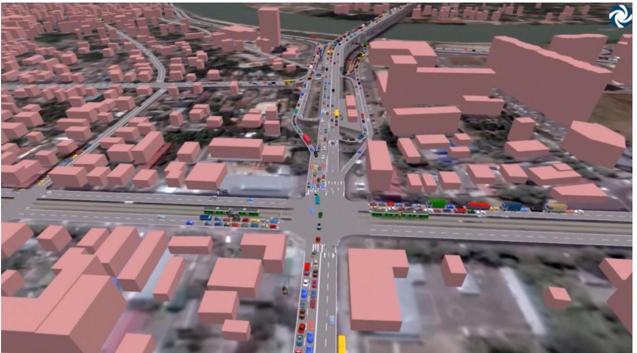
Рисунок 4.14.94 – результат динамического транспортного моделирования в секторе Тургеневского моста, сценарий существующего положения, утренний час-пик
