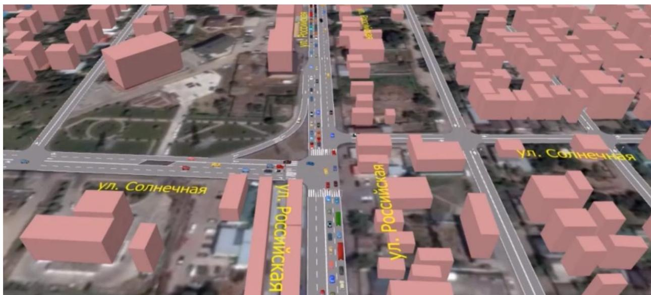
Рисунок 4.14.8 – Динамическая транспортная модель существующего положения на пересечении ул. Российская – ул. Солнечная
