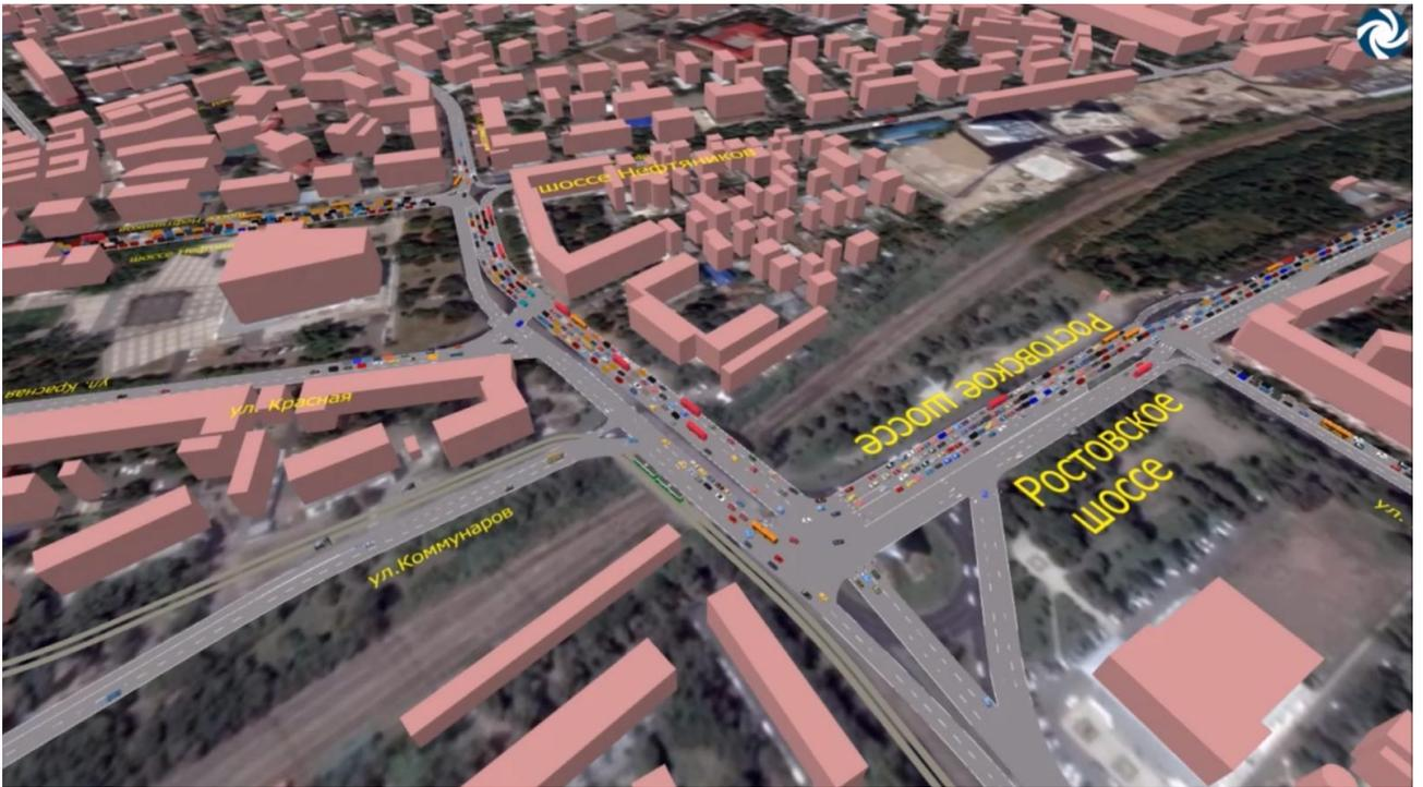
Рисунок 4.14.2 – Динамическая математическая модель транспортной ситуации на пересечениях улицы Офицерская с ул. Ростовское Шоссе, ул. Коммунаров, ул. Красная и ул. Шоссе Нефтяников после реконструкции транспортного узла.
