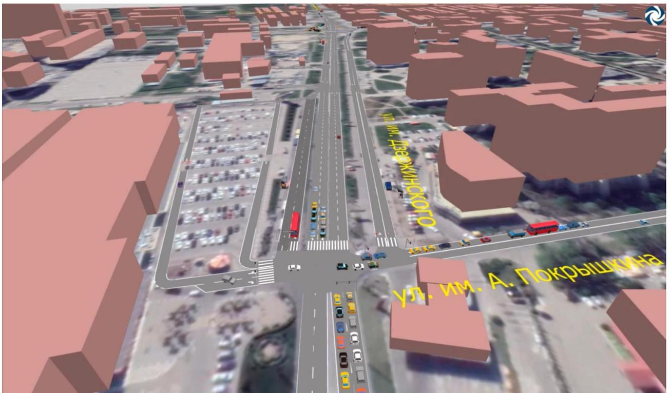
Рисунок 4.14.102 – Результат динамического транспортного моделирования на пересечении ул. им. Дзержинского – ул. им. Александра Покрышкина, сценарий существующего положения, утренний час-пик
