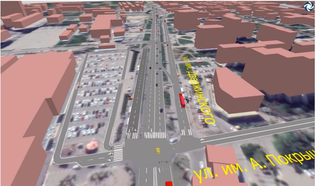
Рисунок 4.14.103 – Результат динамического транспортного моделирования на пересечении ул. им. Дзержинского – ул. им. Александра Покрышкина в проектируемых условиях, утренний час-пик
