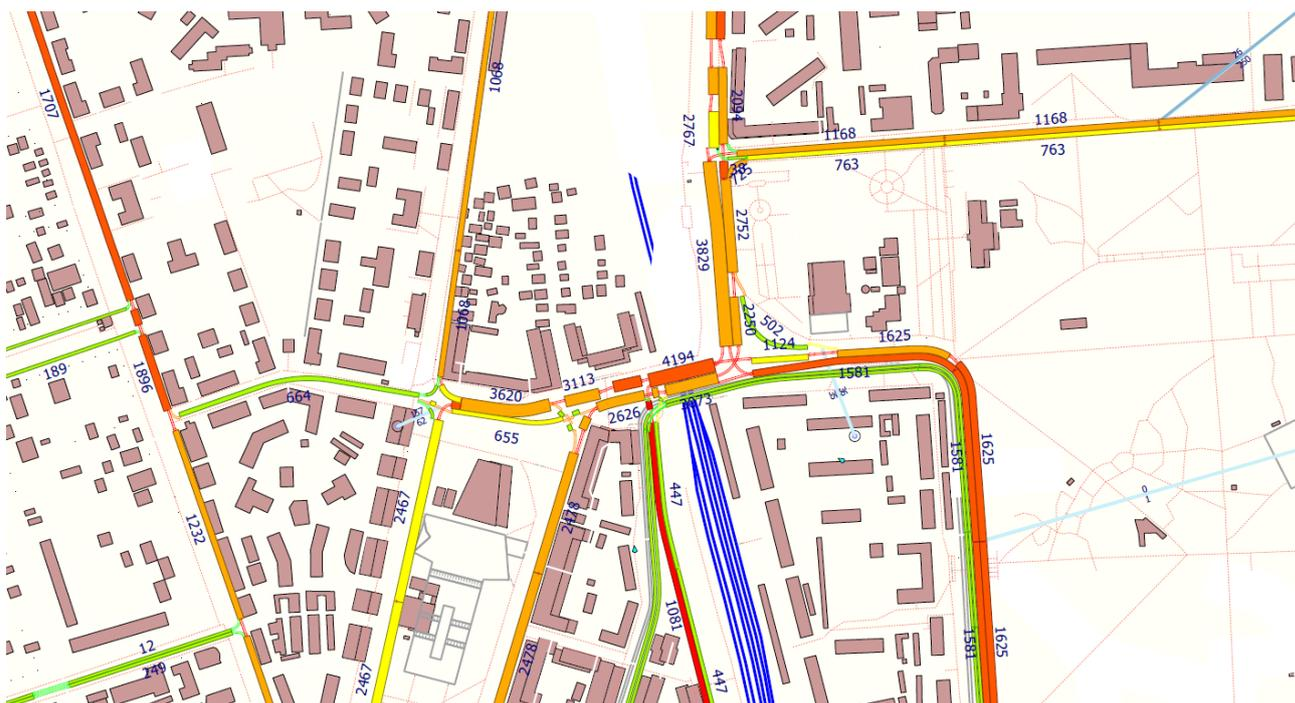
Рисунок 4.3.2 – детализация результата модельного расчета распределения транспортного спроса для сектора пересечения ул. Ростовское Шоссе – ул. Офицерская – ул. Колхозная в утренний час-пик (Базовый сценарий).
