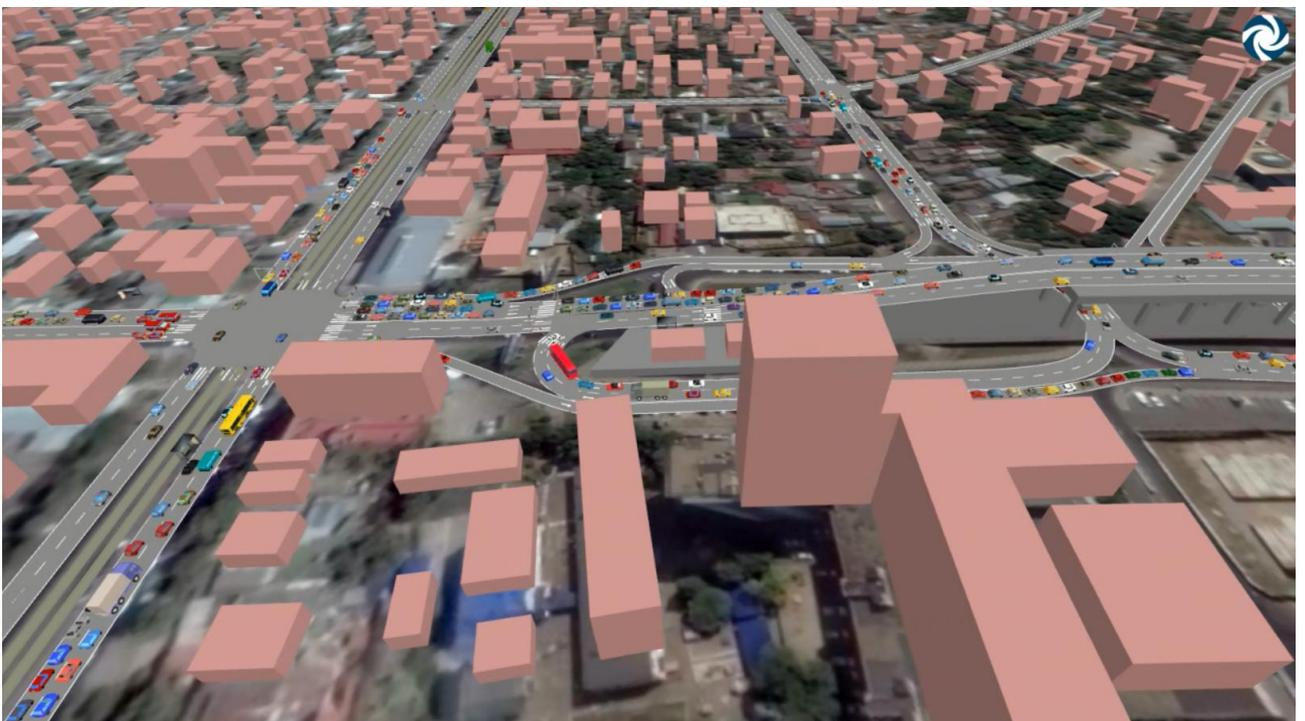
Рисунок 4.14.53 – Динамическая транспортная модель проектируемых условий для вечернего часа пик на пересечениях ул. им. Тургенева – ул. им. Буденного, ул. им. Тургенева – ул. им. Калинина
