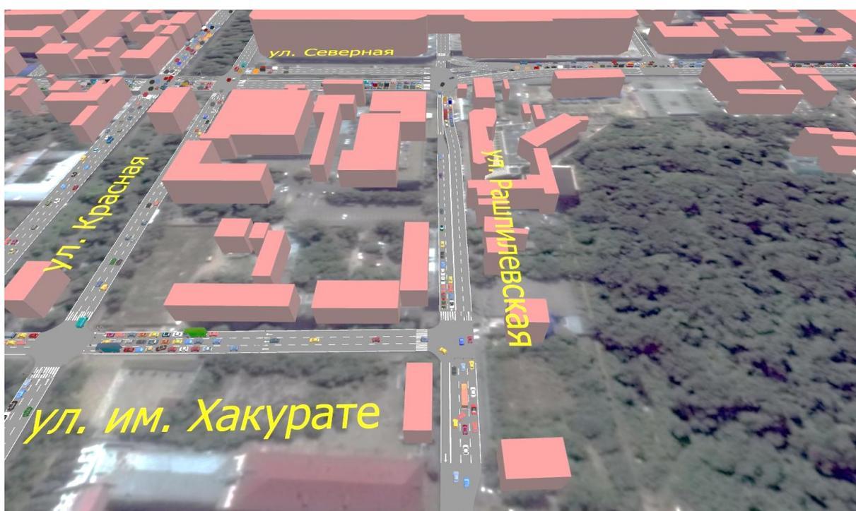
Рисунок 4.14.56 – Динамическая транспортная модель проектируемых условий на пересечении ул. им. Хакурате – ул. Рашпилевская
