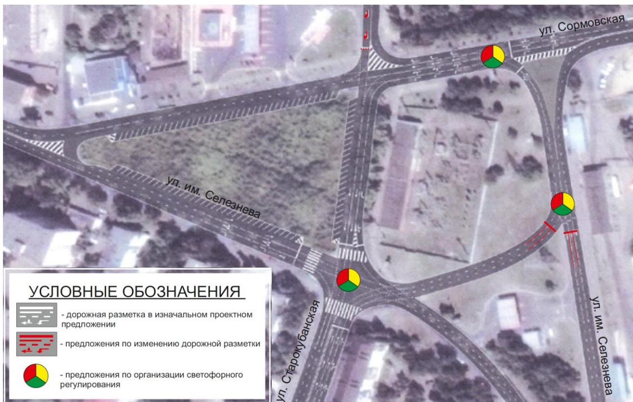
Рисунок – 4.14.86 – оптимизированная схема ОДД на пересечении ул. Сормовская – ул. Старокубанская – ул. им. Селезнева, примененная в транспортной динамической модели
