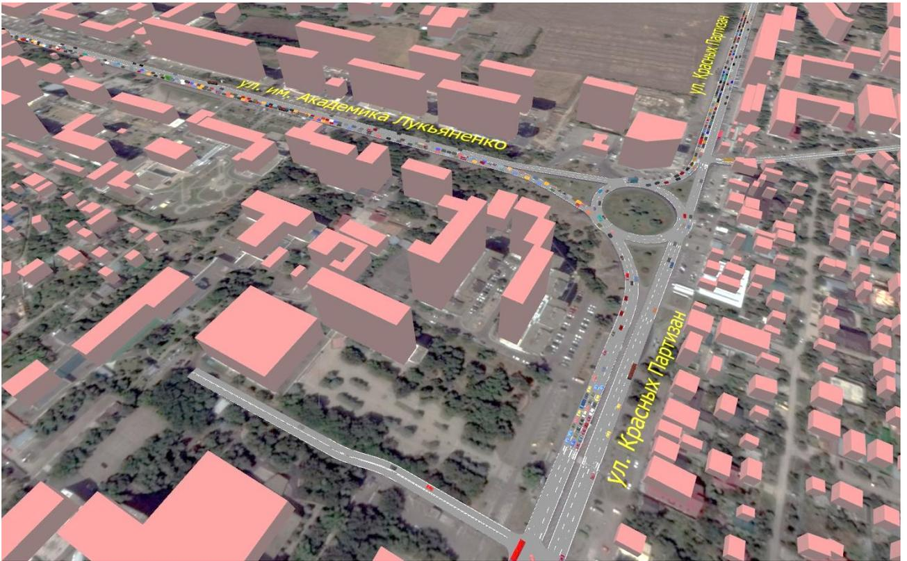
Рисунок 4.14.59 – Динамическая транспортная модель проектируемых условий в зоне транспортного влияния Краевой клинической больницы №2
