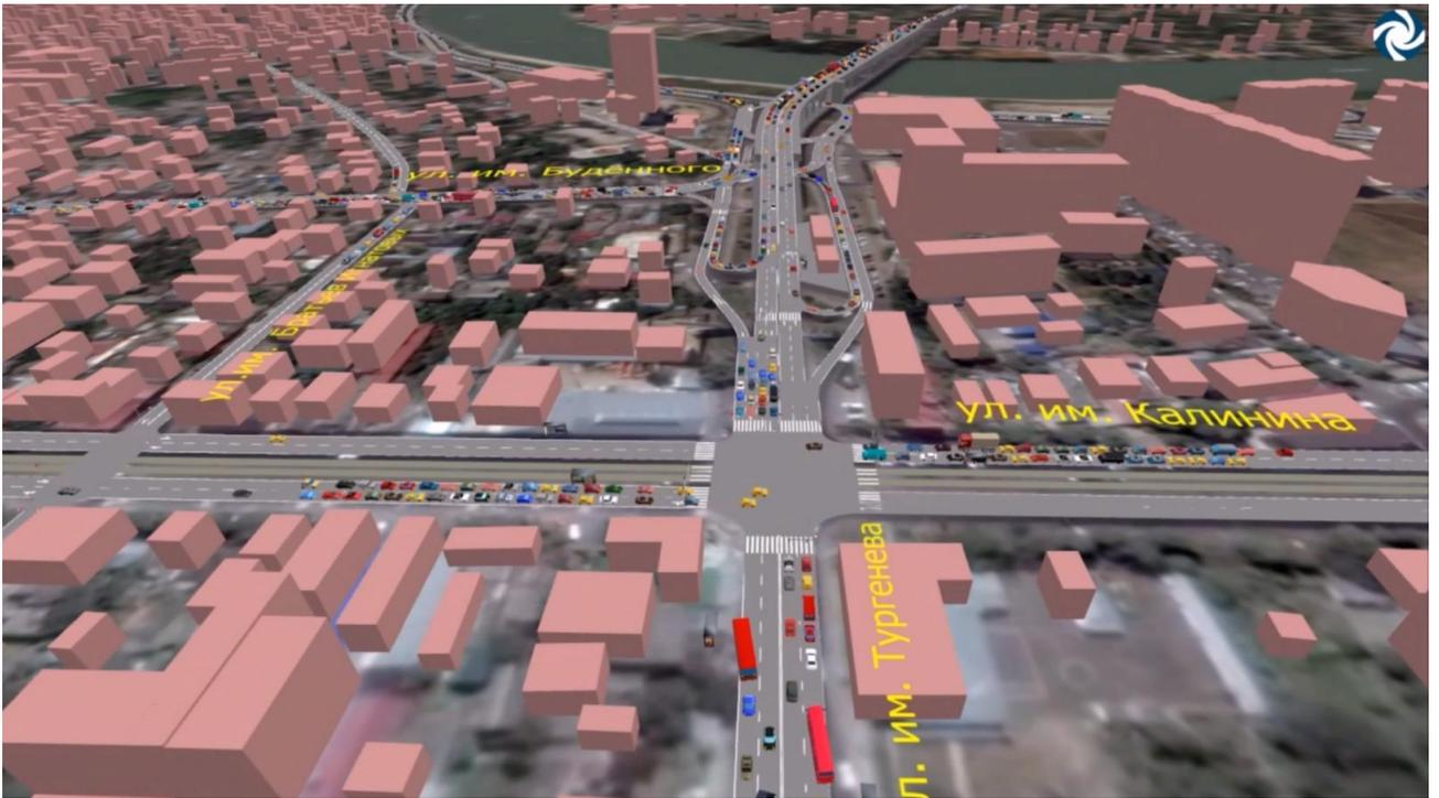
Рисунок 4.14.95 – результат динамического транспортного моделирования в секторе Тургеневского моста, сценарий существующего положения, вечерний час-пик
