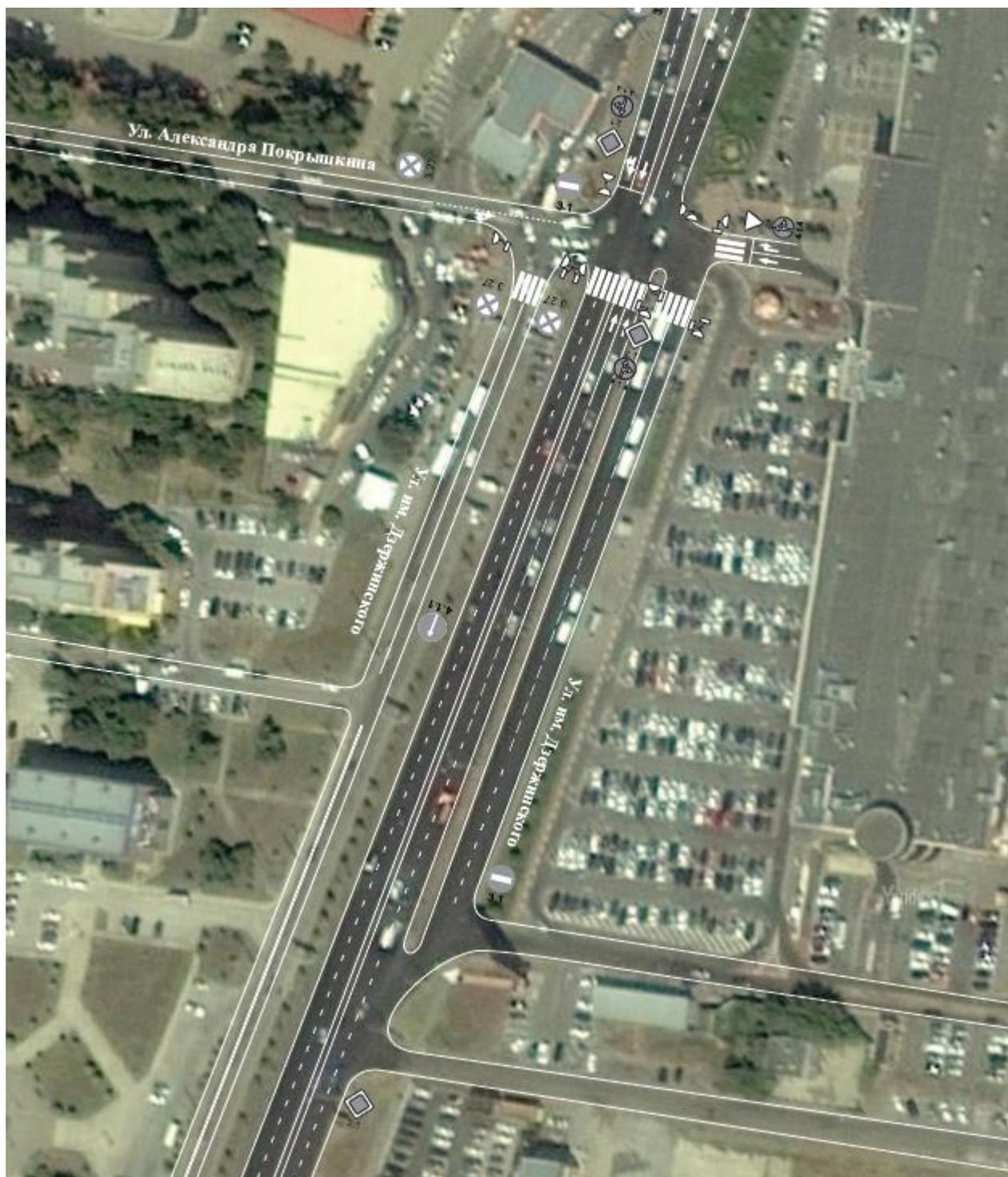
Рисунок – 4.14.98 – Схема ОДД на пересечении ул. им. Дзержинского – ул. им. Александра Покрышкина в существующих условиях
