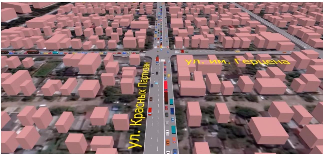
Рисунок 4.14.62 – Результат динамического моделирования на пересечении ул. Красных Партизан – ул. им. Герцена в существующих условиях
