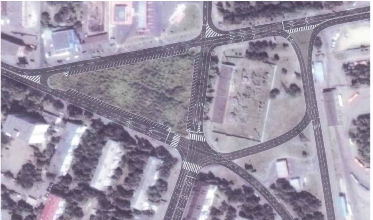
Рисунок – 4.14.85 – схема ОДД на пересечении ул. Сормовская – ул. Старокубанская – ул. им. Селезнева, предложенная Заказчиком для проверки работоспособности решения на транспортной модели
