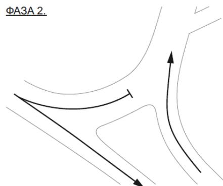
Рисунок 4.14.43 – Режим светофорного регулирования на пересечении ул. им. Тургенева – ул. Кубанская Набережная в существующих условиях
