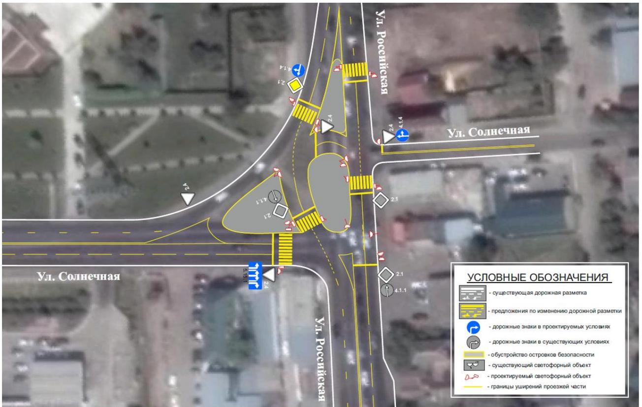
Рисунок 4.14.9 – Схема ОДД на пересечении ул. Российская – ул. Солнечная (вариант №1), предлагаемая к реализации до применения методов динамического транспортного моделирования
