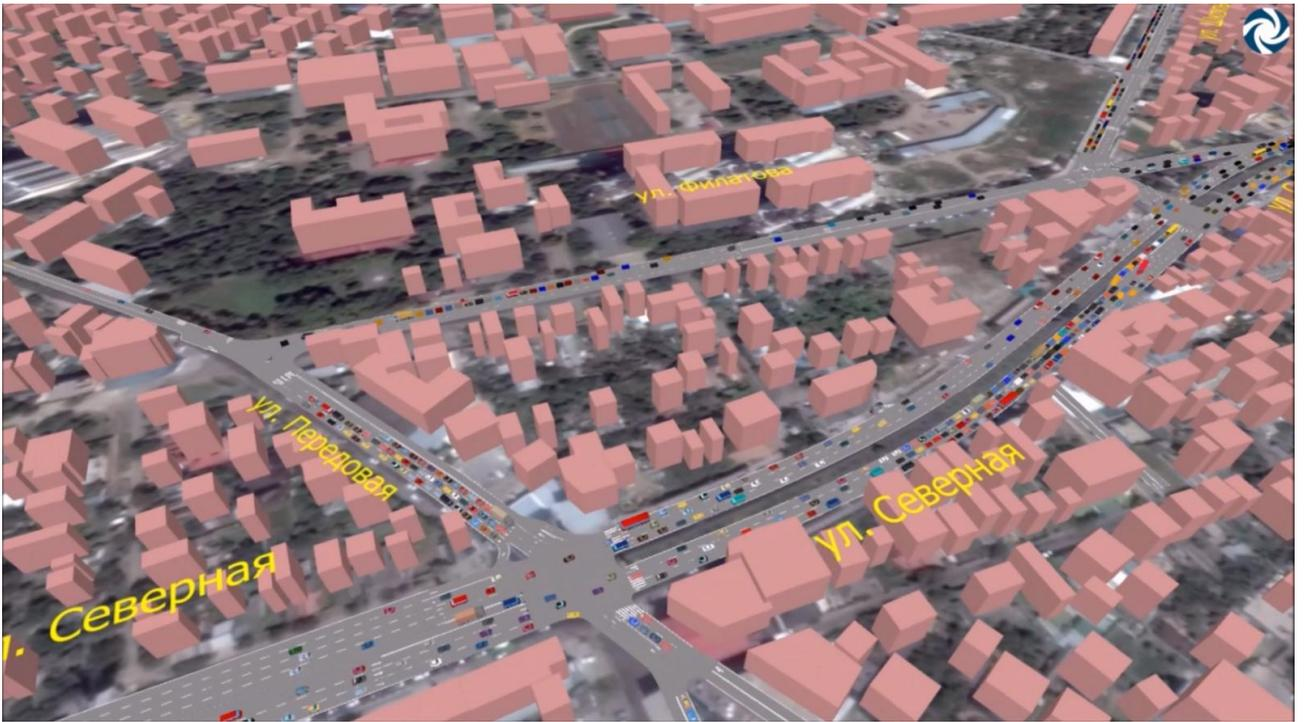
Рисунок 4.14.15 – Динамическая транспортная модель существующего положения на пересечении ул. Северная – ул. Передовая
