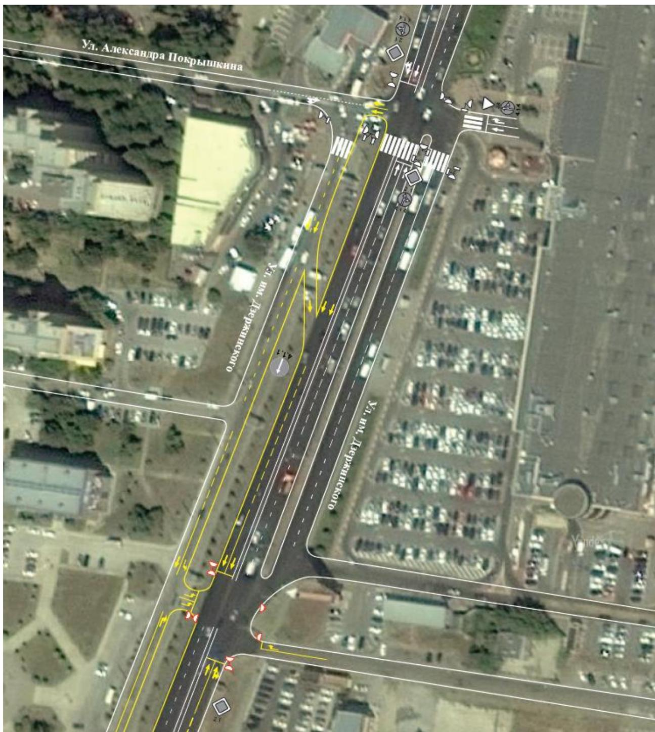
Рисунок – 4.14.100 – Схема ОДД на пересечении ул. им. Дзержинского – ул. им. Александра Покрышкина в проектируемых условиях
