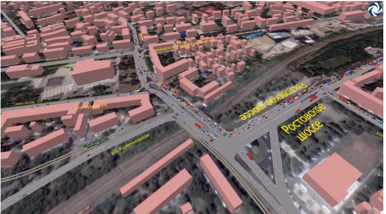
Рисунок 4.14.7 – Динамическая транспортная модель проектируемых условий на пересечениях улицы Офицерская с ул. Ростовское Шоссе, ул. Коммунаров, ул. Красная и ул. Шоссе Нефтяников
