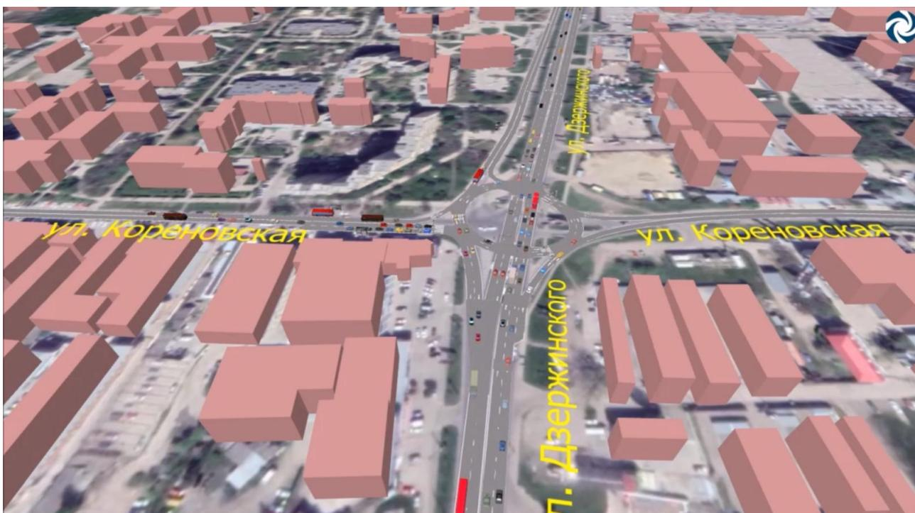
Рисунок 4.14.37 – Динамическая транспортная модель проектируемых условий на пересечении ул. им. Дзержинского – ул. Кореновская
