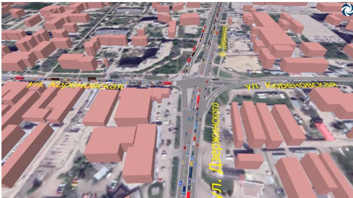
Рисунок 4.14.35 – Динамическая транспортная модель существующих условий на пересечении ул. им. Дзержинского – ул. Кореновская
