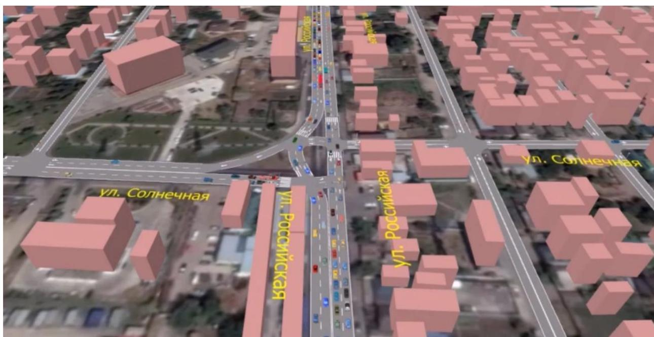
Рисунок 4.14.12 – Динамическая транспортная модель проектируемых условий на пересечении ул. Российская – ул. Солнечная (вариант №1)
