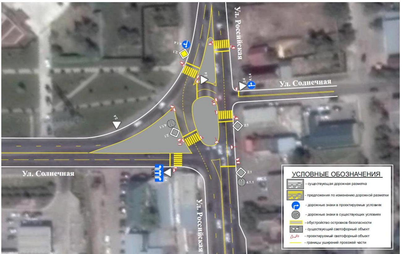
Рисунок 4.14.10 – Оптимизированная схема ОДД на пересечении ул. Российская – ул. Солнечная (вариант №1) в проектируемых условиях
