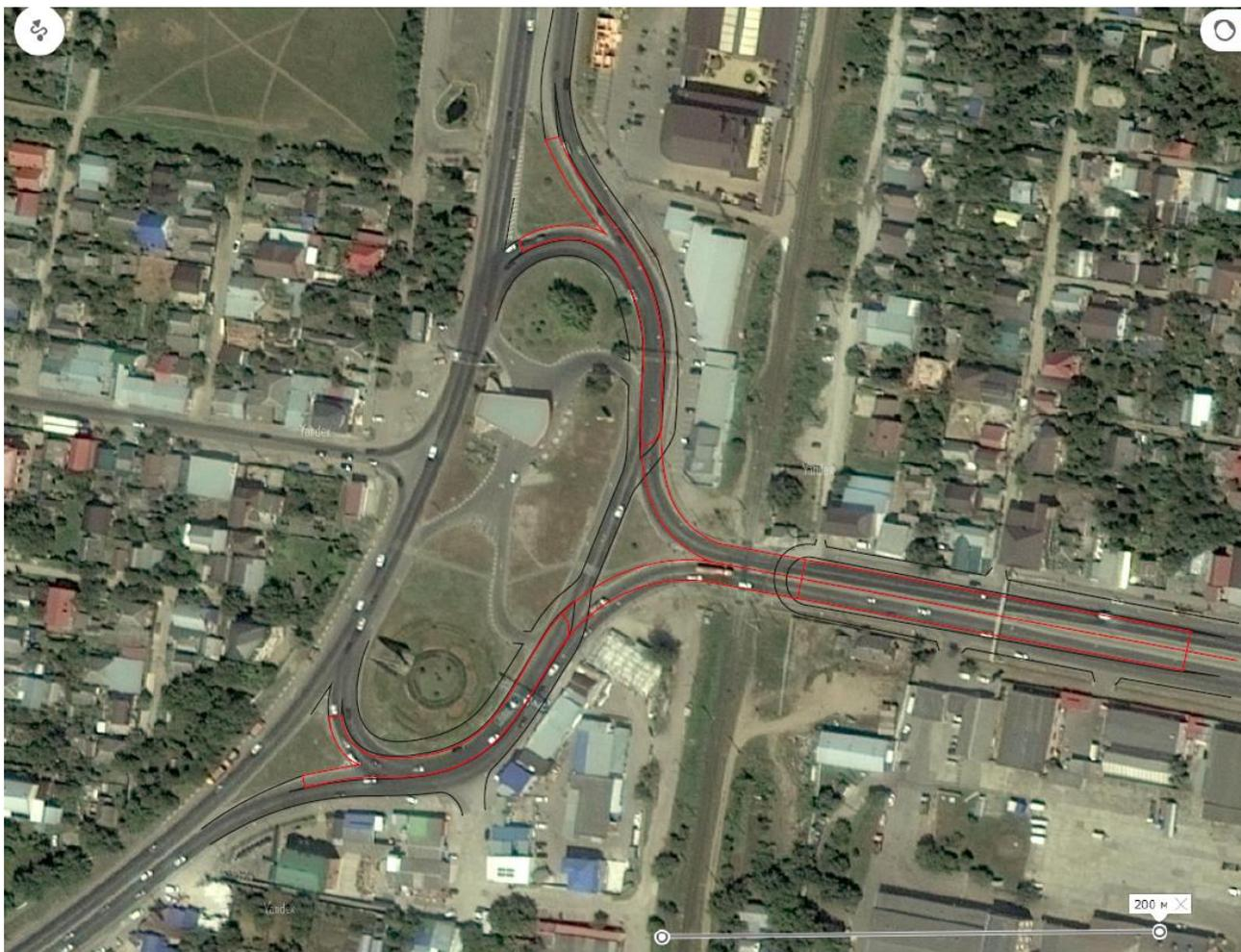
Рисунок 4.14.90 – Схема проектируемого путепровода на пересечении ул. им. Дзержинского – ул. 3-я Трудовая
