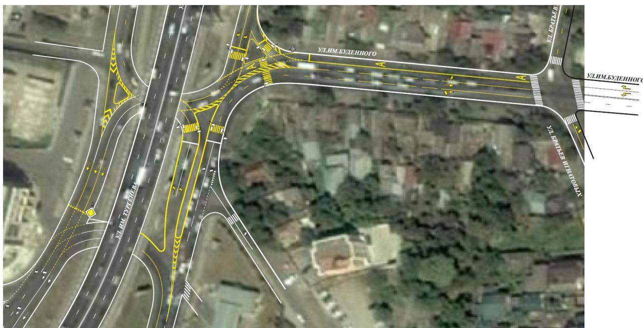
Рисунок 4.14.92 – схема ОДД на пересечении ул. им. Буденного – ул. им. Тургенева и ул. им. Буденного – ул. им. Братьев Игнатовых в проектируемых условиях (Вариант 2)
