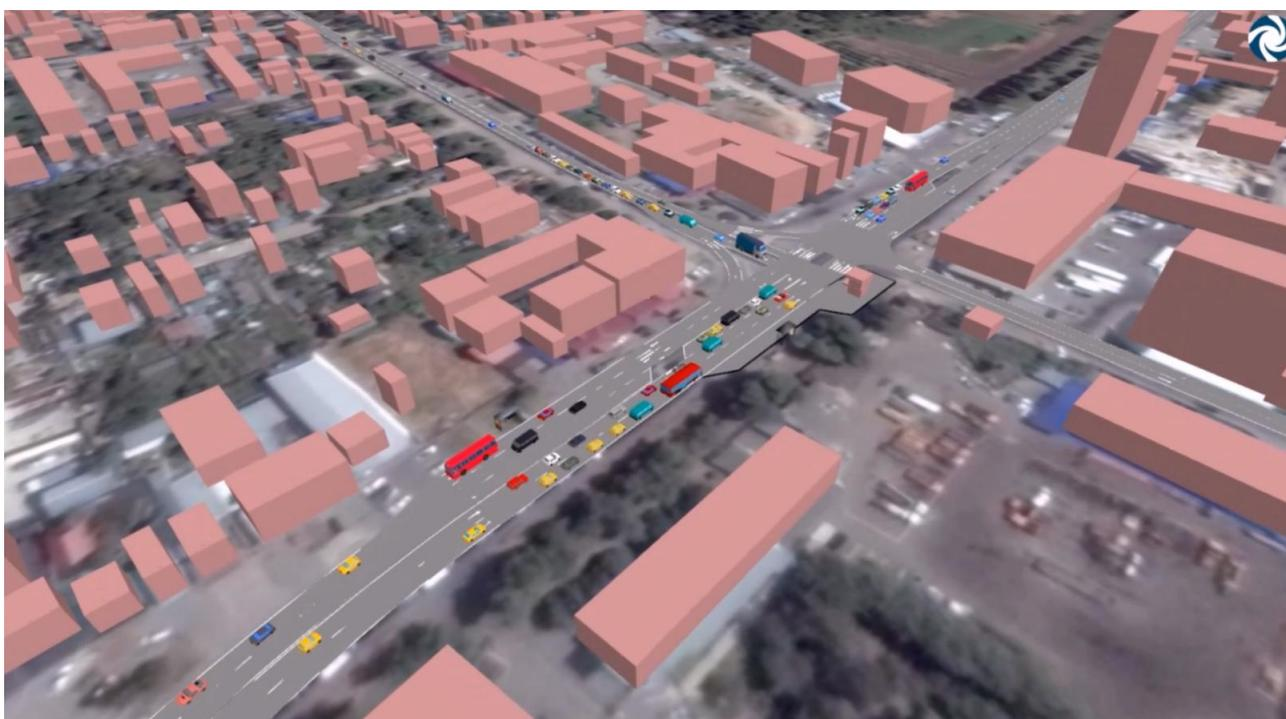
Рисунок 4.14.73 – Результат динамического моделирования на пересечении ул. Бородинская – ул. Почтовая в проектируемых условиях
