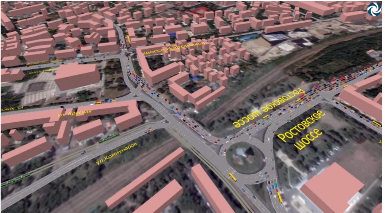
Рисунок 4.14.1 – Динамическая математическая модель транспортной ситуации на пересечениях улицы Офицерская с ул. Ростовское Шоссе, ул. Коммунаров, ул. Красная и ул. Шоссе Нефтяников до реконструкции транспортного узла.
