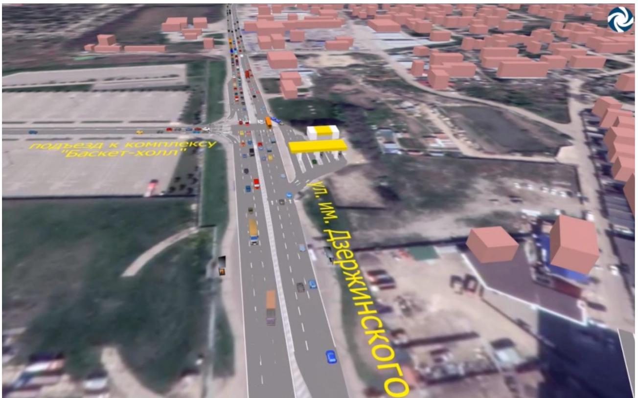
Рисунок 4.14.70 - Результат динамического моделирования на пересечении ул. им. Дзержинского, д.108 – подъезд к СК «Баскет-Холл» в проектируемых условиях
