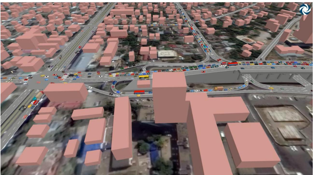
Рисунок 4.14.47 – Динамическая транспортная модель существующих условий в вечерний час-пик на пересечениях ул. им. Тургенева – ул. им. Буденного, ул. им. Тургенева – ул. им. Калинина
