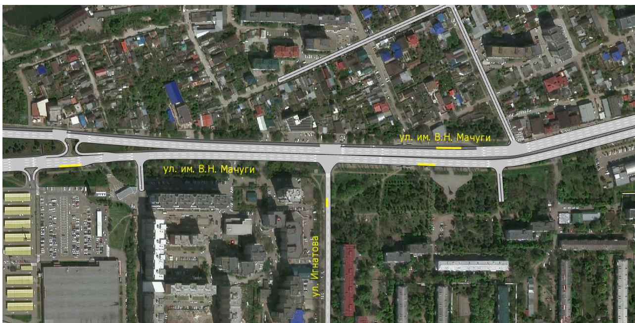
Рисунок 3.21.115 – Схема организации движения в секторе пересечения ул. им. Мачуги В.Н. - ул. им. Игнатова в проектируемых условиях
