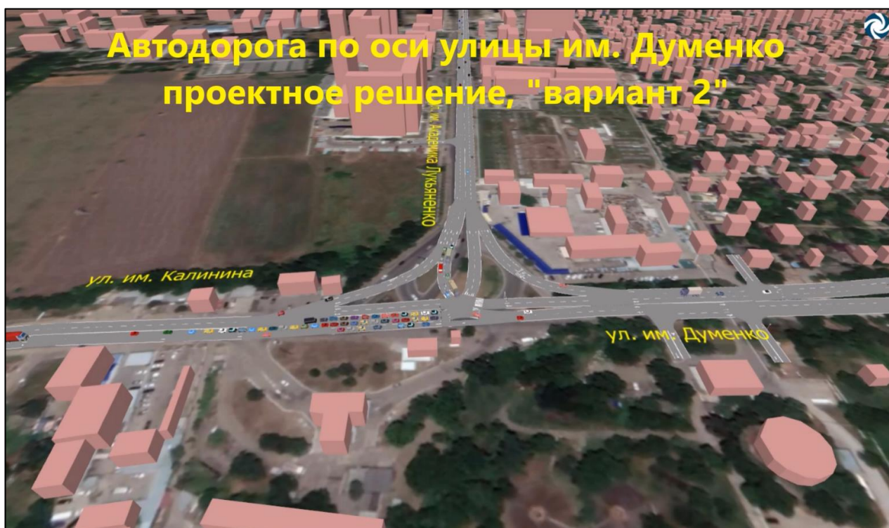
Рисунок 3.21.128 – динамическое транспортное моделирование дорожно-транспортной ситуации на пересечении ул. им. Калинина – ул. им. Академика Лукьяненко П.П. – а/д «По оси ул. им. Думенко» по оптимизированному проектному решению (Вариант 2)
