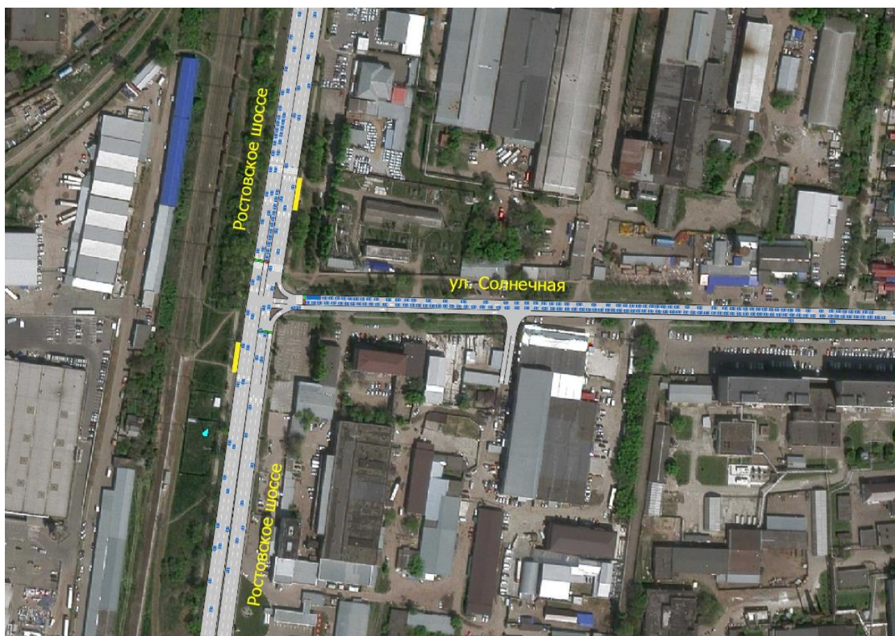
Рисунок 3.21.31 - Результат динамического моделирования дорожно-транспортной ситуации на пересечении ул. Ростовское Шоссе - ул. Солнечная в существующих условиях
