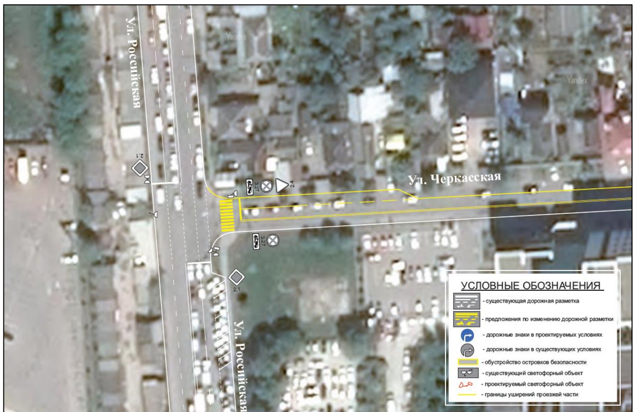
Рисунок 3.21.37 – Схема ОДД на пересечении ул. Российская – ул. Черкасская в проектируемых условиях
