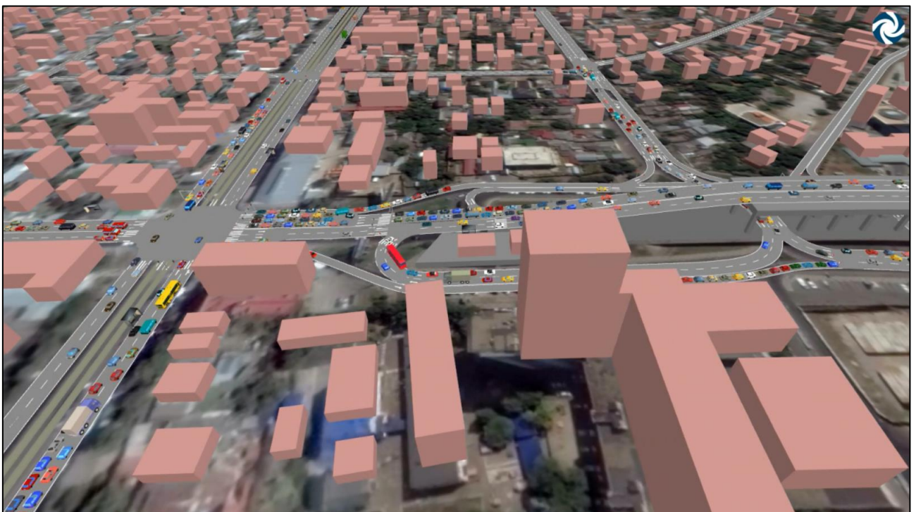
Рисунок 3.21.105 – Динамическая транспортная модель проектируемых условий для вечернего часа пик на пересечениях ул. им. Тургенева – ул. им. Буденного, ул. им. Тургенева – ул. им. Калинина
