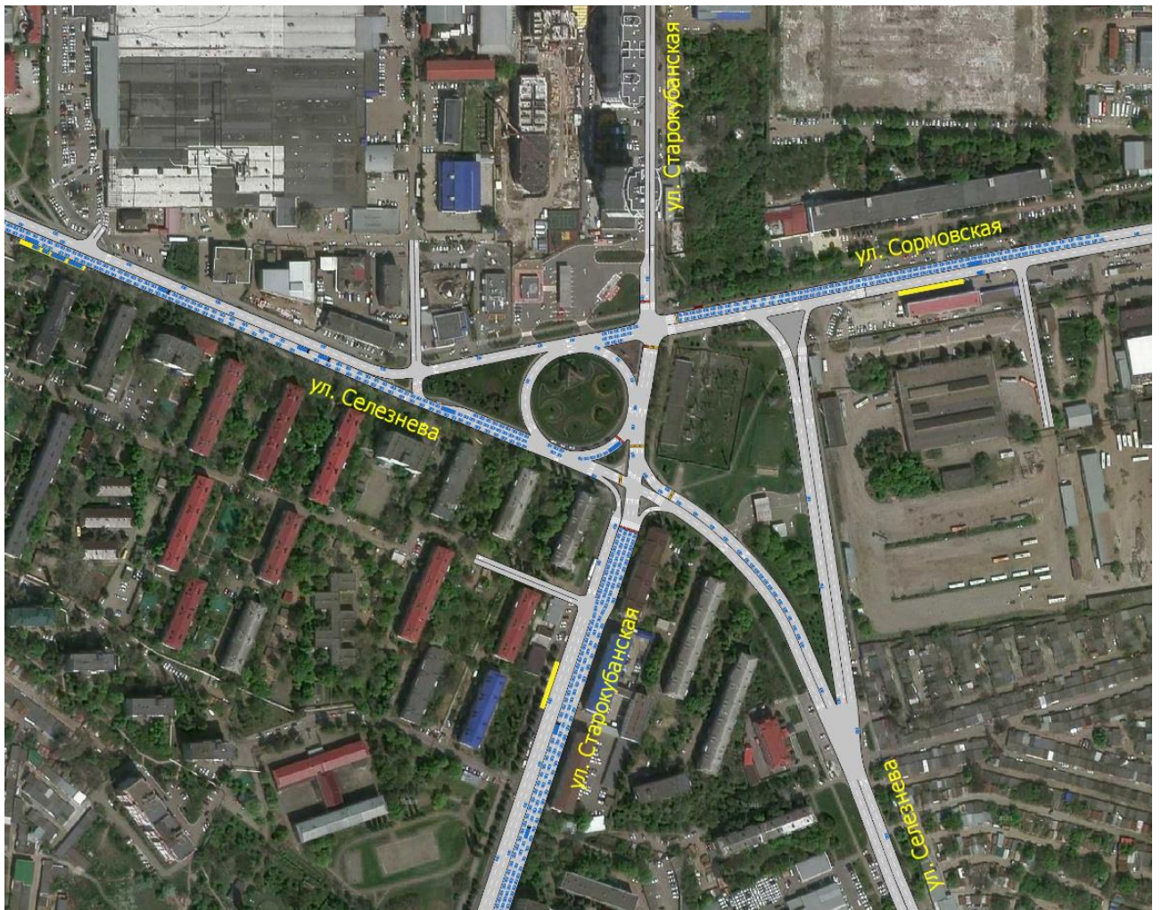
Рисунок 3.21.113 - Результат динамического моделирования дорожно-транспортной ситуации на пересечении ул. им. Селезнева - ул. Старокубанская - ул. Сормовская в существующих условиях
