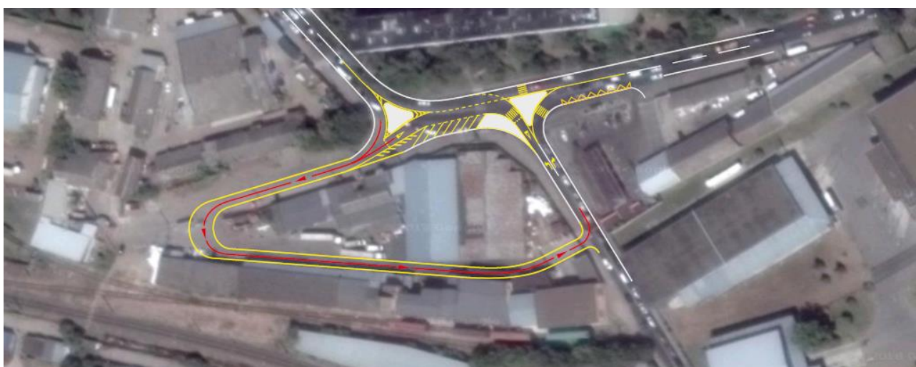
Рисунок 3.21.65 – Схема движения в районе пересечения ул. Спортивная – ул. Ипподромная – ул. Передовая в проектируемых условиях
