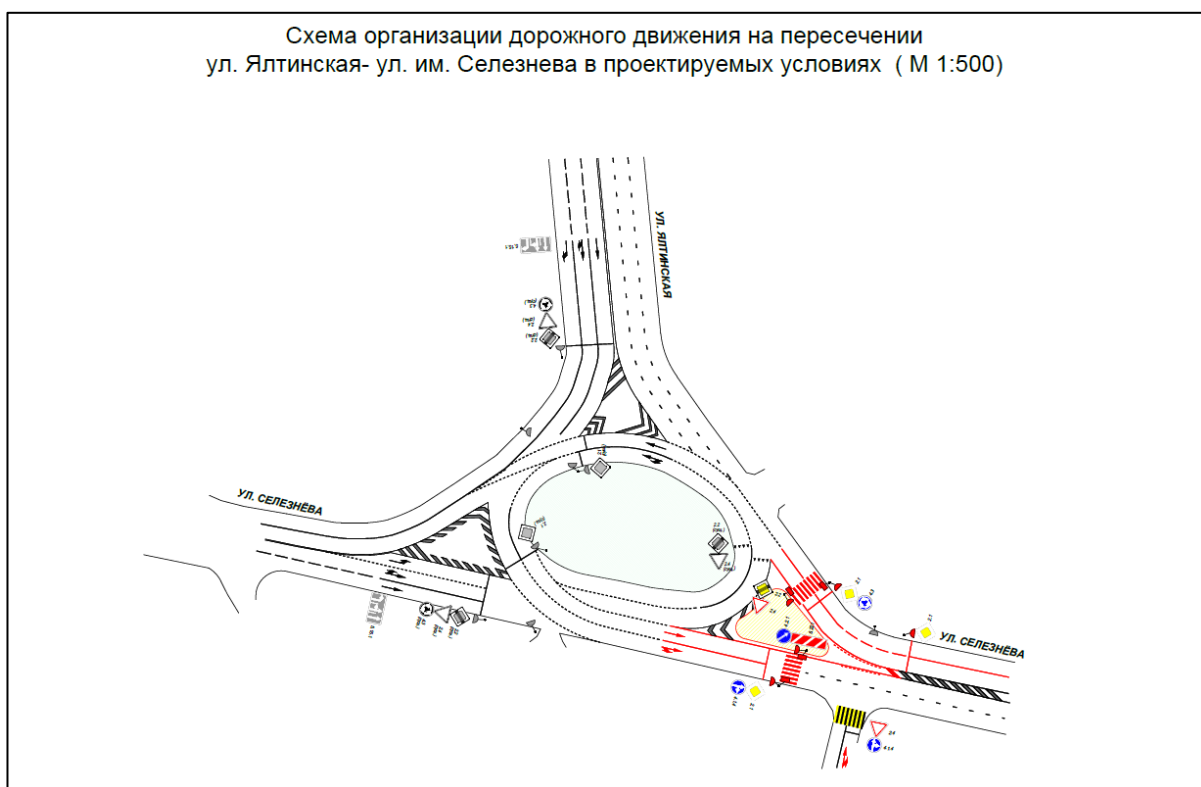
Рисунок 3.21.106 – Схема ОДД на пересечении ул. Ялтинская - ул. им. Селезнева в проектируемых условиях
