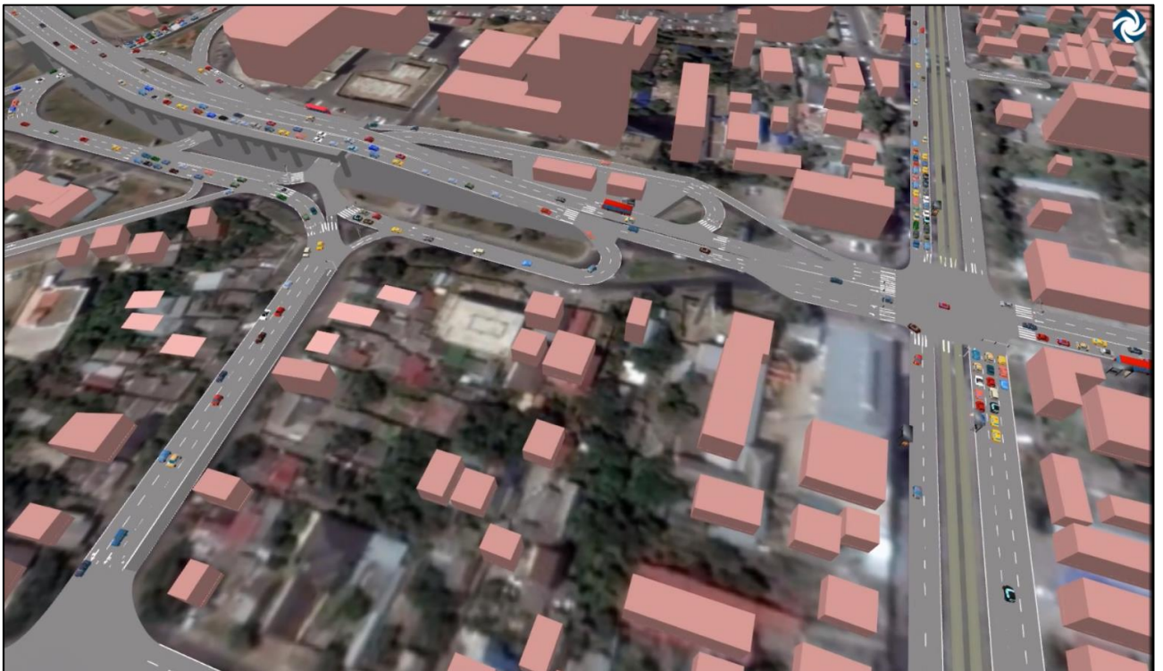
Рисунок 3.21.140 – результат динамического транспортного моделирования в секторе Тургеневского моста, сценарий реализации проектных предложений по Варианту 2, утренний час-пик
