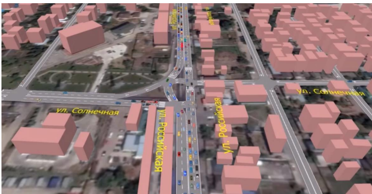
Рисунок 3.21.35 – Динамическая транспортная модель проектируемых условий на пересечении ул. Российская – ул. Солнечная
