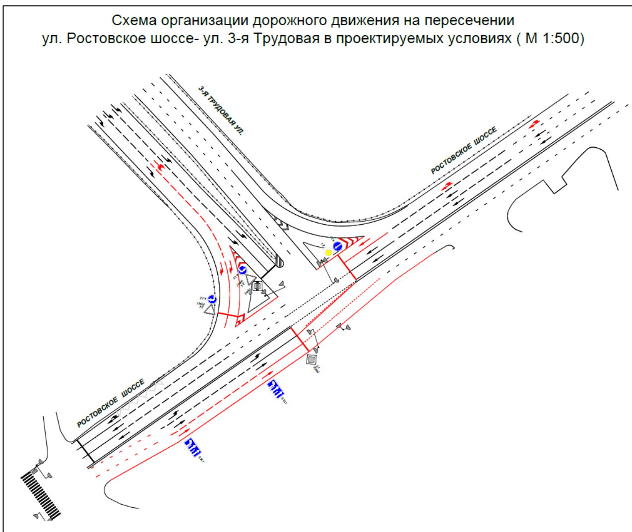
Рисунок 3.21.21 – Схема ОДД на пересечении ул. Ростовское Шоссе - ул. 3-я Трудовая в проектируемых условиях
