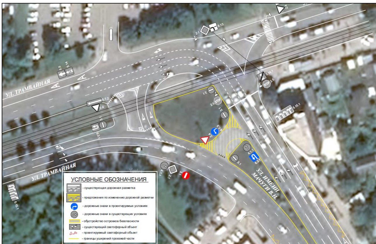
Рисунок 3.21.122 – Схема ОДД на пересечении ул. Трамвайная – ул. им. Мачуги В.Н. в проектируемых условиях
