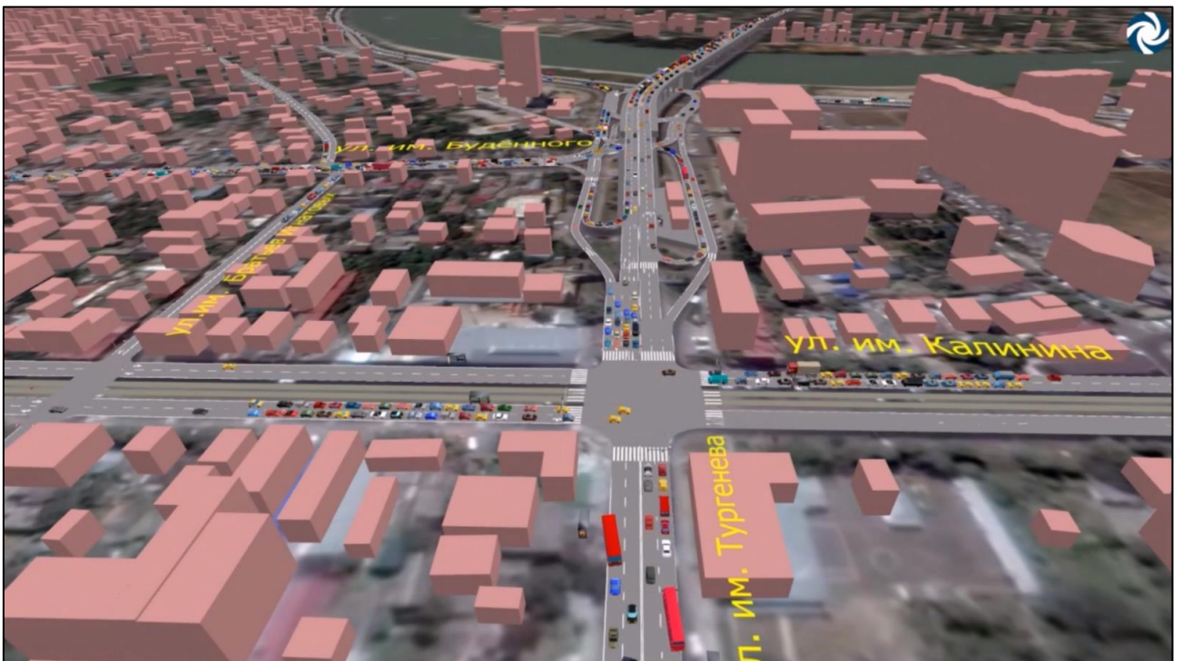
Рисунок 3.21.138 – результат динамического транспортного моделирования в секторе Тургеневского моста, сценарий существующего положения, вечерний час-пик
