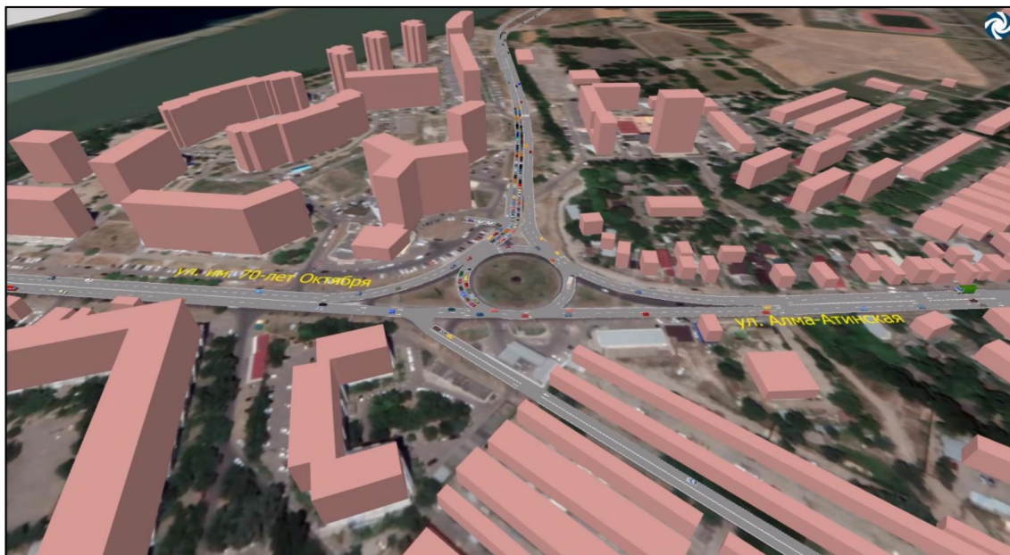
Рисунок 3.21.132 – динамическое транспортное моделирование дорожно-транспортной ситуации на пересечении ул. им. 70-летия Октября – ул. Алма-Атинская – ул. им. Думенко по изначальному проектному решению (Вариант 1)
