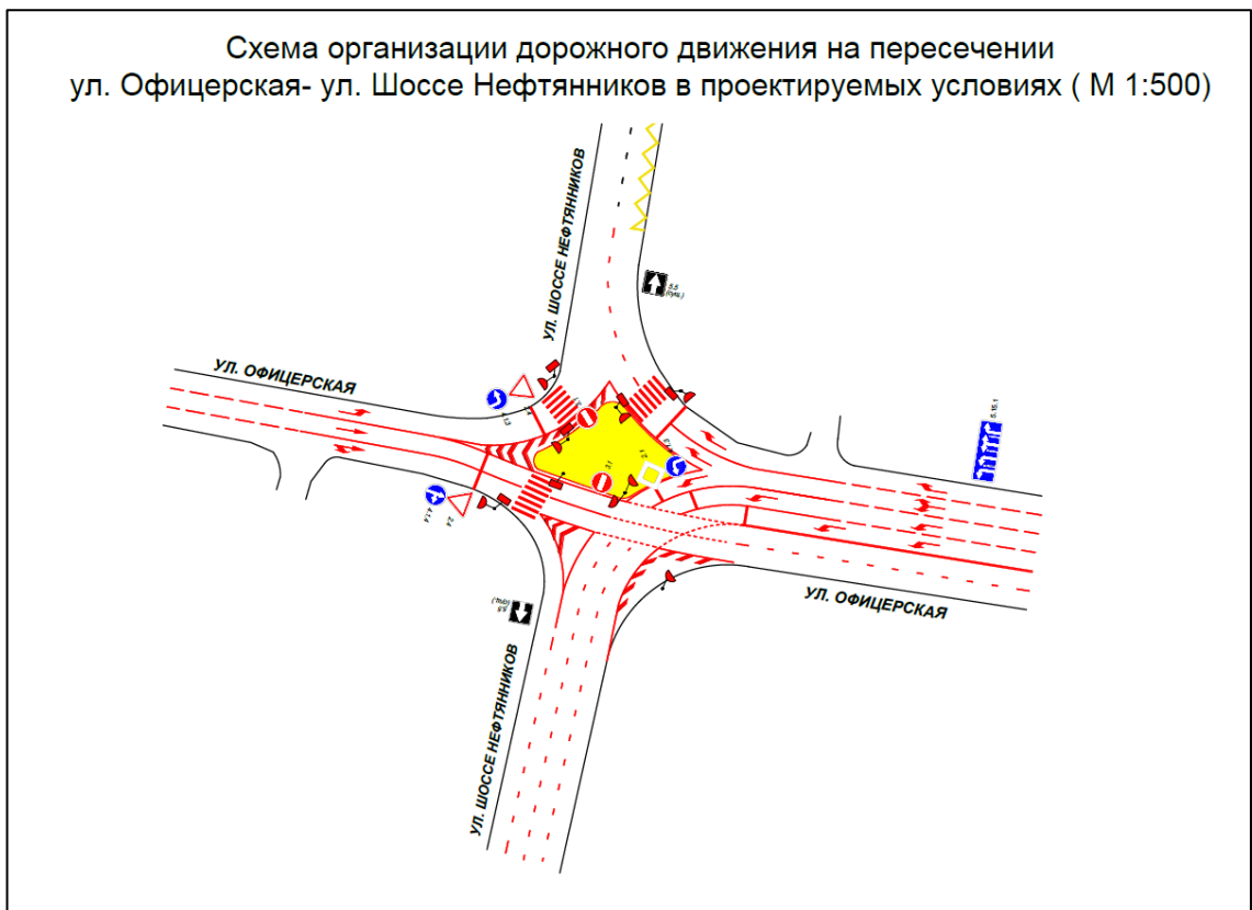
Рисунок 3.21.54 – Схема организации дорожного движения на пересечении ул. Офицерская - ул. Шоссе Нефтянников в проектируемых условиях
