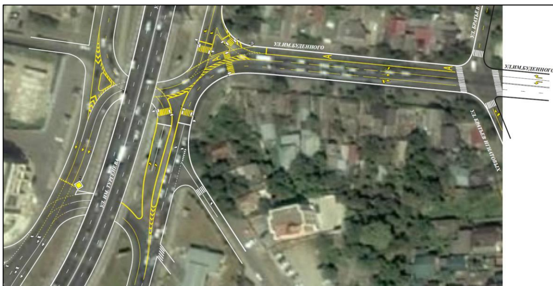
Рисунок 3.21.135 – схема ОДД на пересечении ул. им. Буденного – ул. им. Тургенева и ул. им. Буденного – ул. им. Братьев Игнатовых в проектируемых условиях (Вариант 2)
