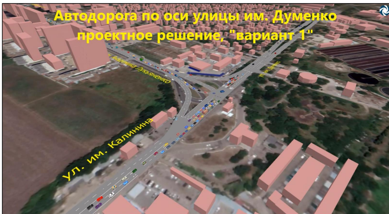
Рисунок 3.21.127 – динамическое транспортное моделирование дорожно-транспортной ситуации на пересечении ул. им. Калинина – ул. им. Академика Лукьяненко П.П. – а/д «По оси ул. им. Думенко» по изначальному проектному решению (Вариант 1)
