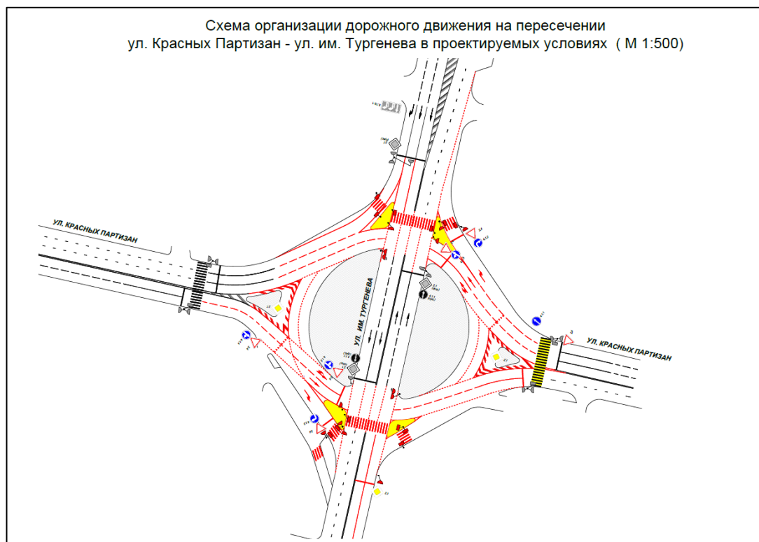
Рисунок 3.21.81 – Схема ОДД на пересечении ул. Красных Партизан - ул. им. Тургенева в проектируемых условиях
