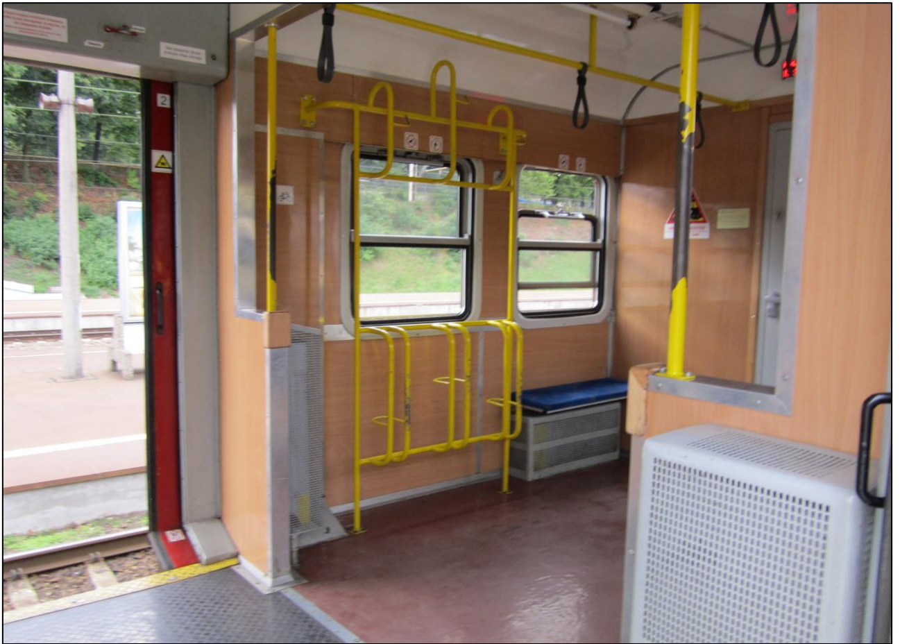
Рисунок 3.5.5 – Тамбур городского электропоезда, приспособленный для перевозки пассажиров с велосипедами.
