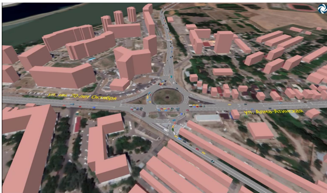
Рисунок 3.21.133 – динамическое транспортное моделирование дорожно-транспортной ситуации на пересечении ул. им. 70-летия Октября – ул. Алма-Атинская – ул. им. Думенко по оптимизированному проектному решению (Вариант 2)
