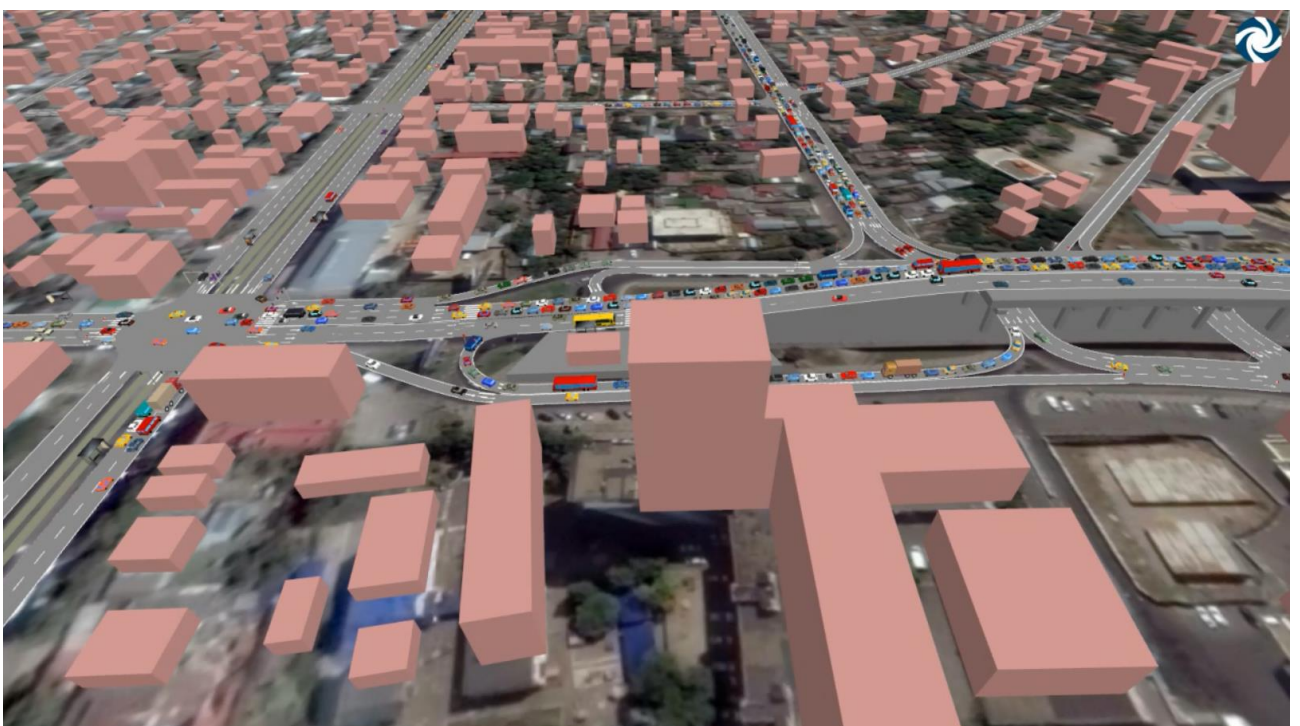
Рисунок 3.21.99 – Динамическая транспортная модель существующих условий в вечерний час-пик на пересечениях ул. им. Тургенева – ул. им. Буденного, ул. им. Тургенева – ул. им. Калинина
