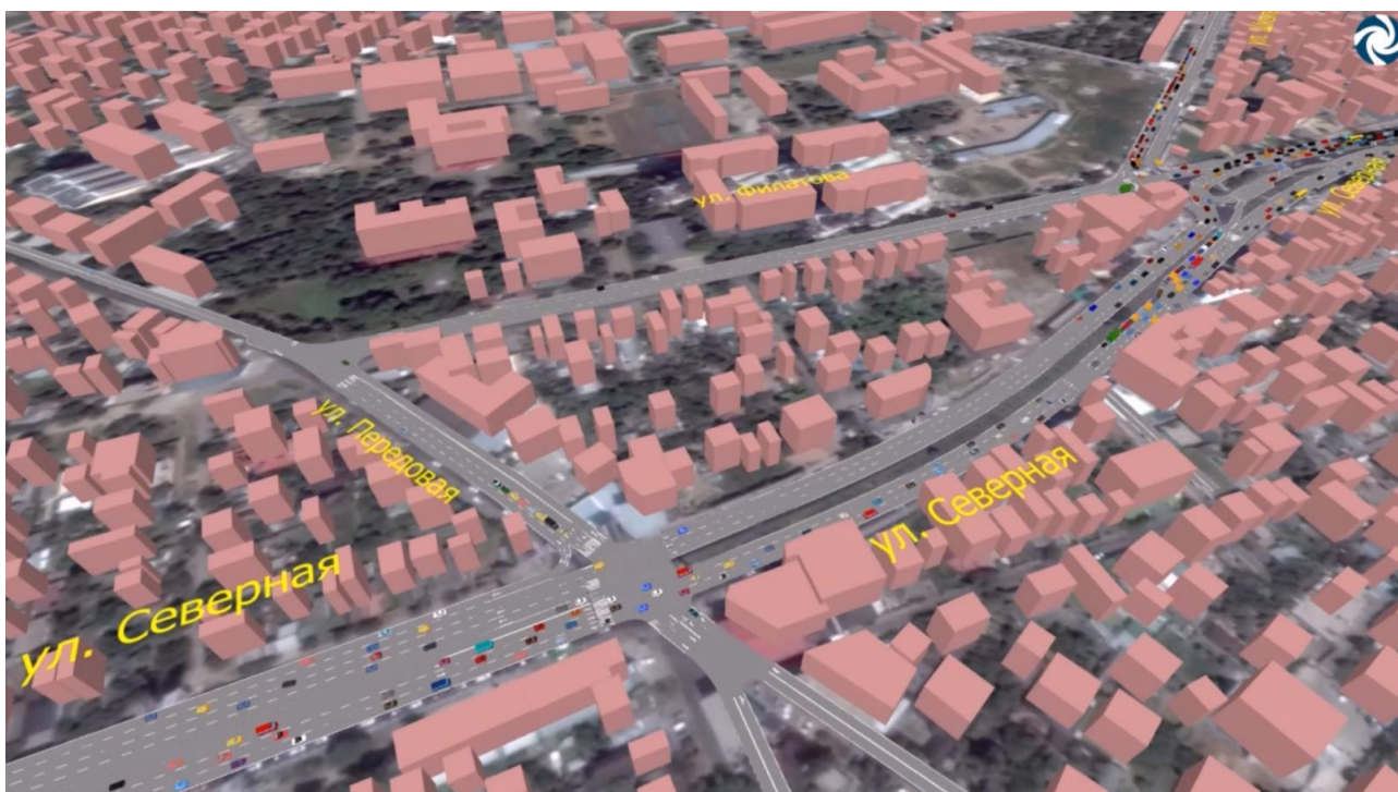
Рисунок 3.21.74 – Динамическая транспортная модель проектируемых условий на пересечении ул. Северная – ул. Передовая
