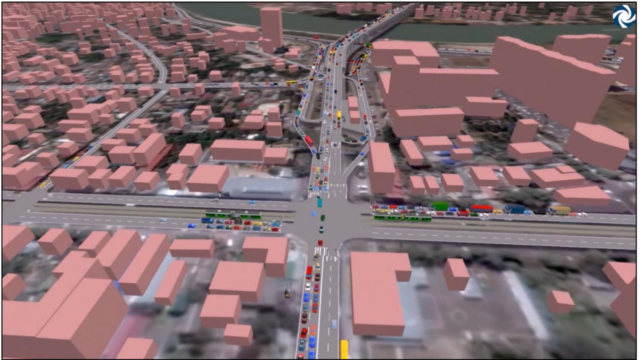
Рисунок 3.21.137 – результат динамического транспортного моделирования в секторе Тургеневского моста, сценарий существующего положения, утренний час-пик
