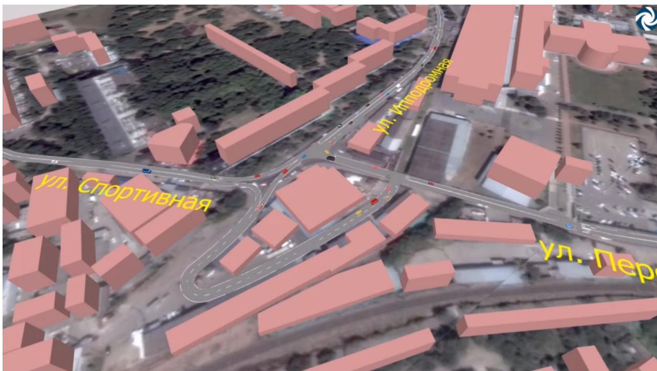
Рисунок 3.21.75 – Динамическая транспортная модель проектируемых условий на пересечении ул. Спортивная – ул. Ипподромная – ул. Передовая
