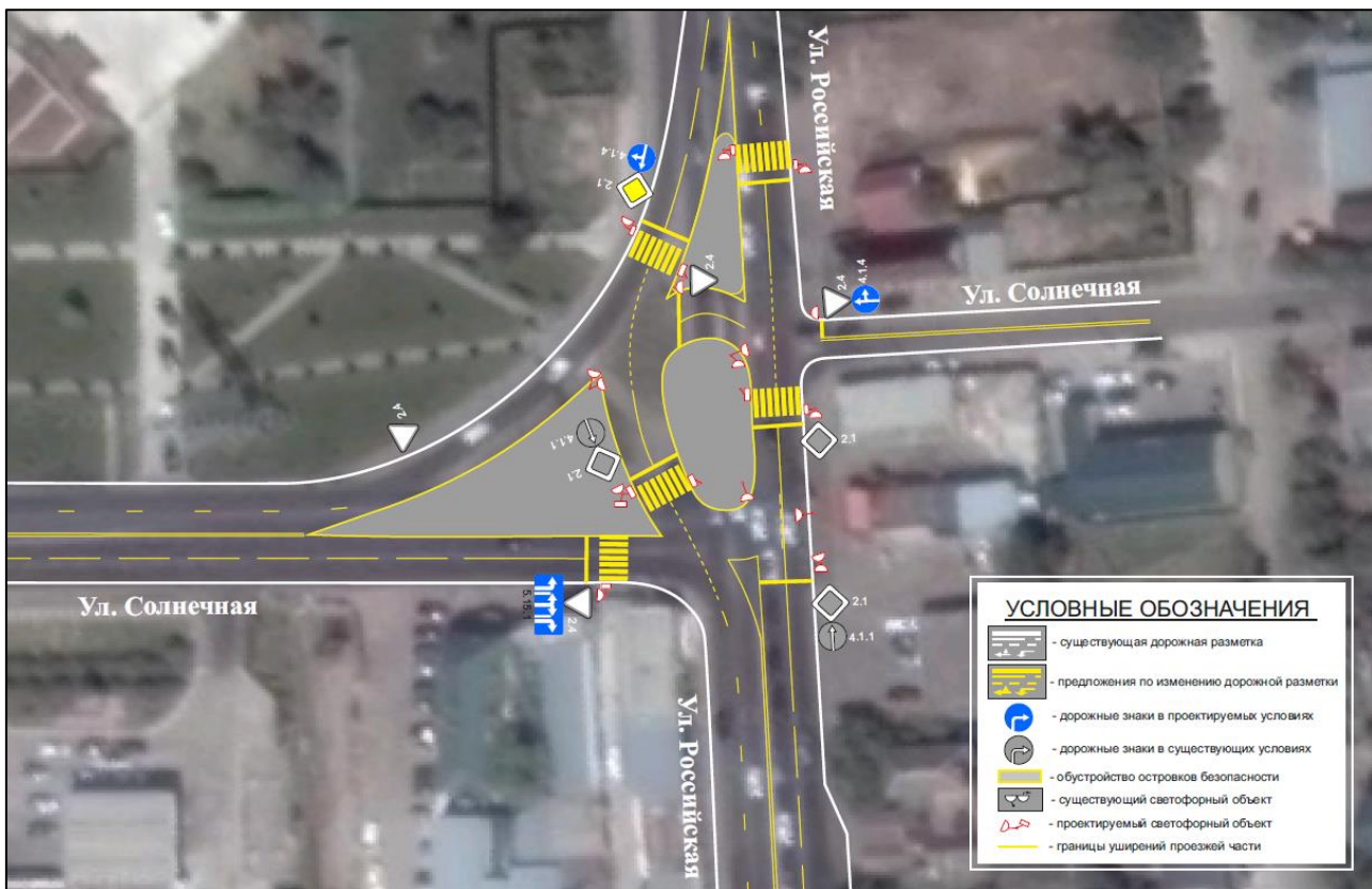
Рисунок 3.21.33 – Схема ОДД на пересечении ул. Российской – ул. Солнечная в проектируемых условиях
