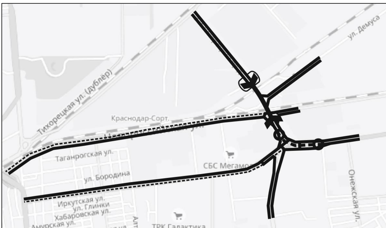
Рисунок 3.21.118 – Схема движения в районе пересечений ул. Уральская – ул. им. Лизы Чайкиной и ул. Новороссийская – ул. им. Лизы Чайкиной в проектируемых условиях
