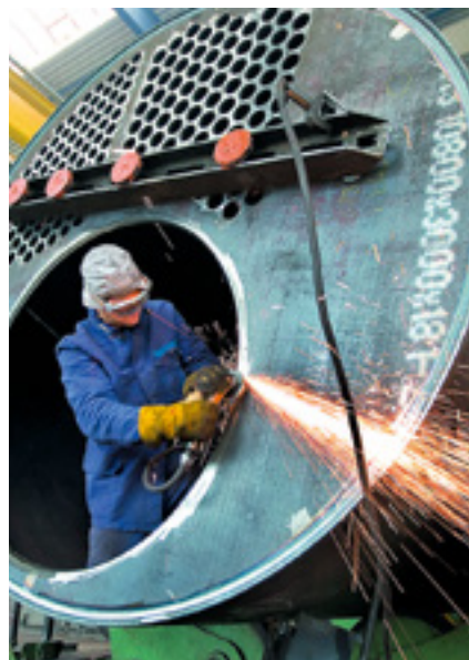
Schweißen des Gasboilers | Bild: Bosch
