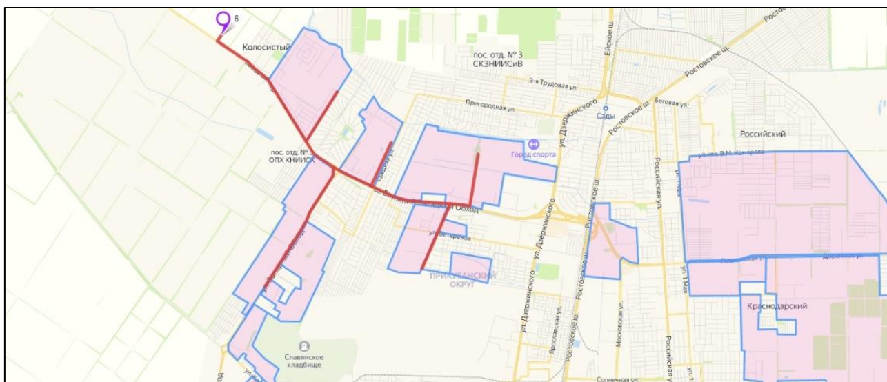
Рис. 3.11. Предварительная схема расположения ТЭЦ и магистральных тепломагистралей в Западном районе города
